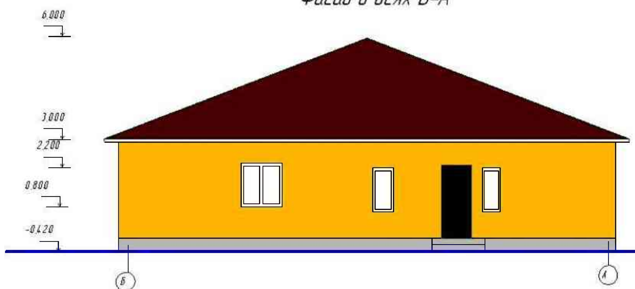
Фасад в осях Б-А
